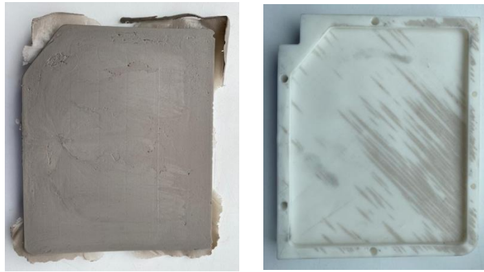
Рис. 5.18. Внешний вид экспериментальной отливки, полученной в экспресс-форме
