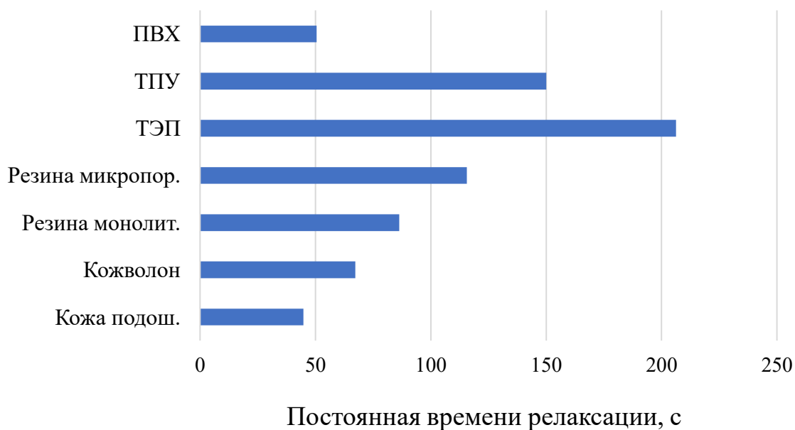
Рис. 2.49. Время релаксации электростатического заряда материалов наружных деталей низа обуви
