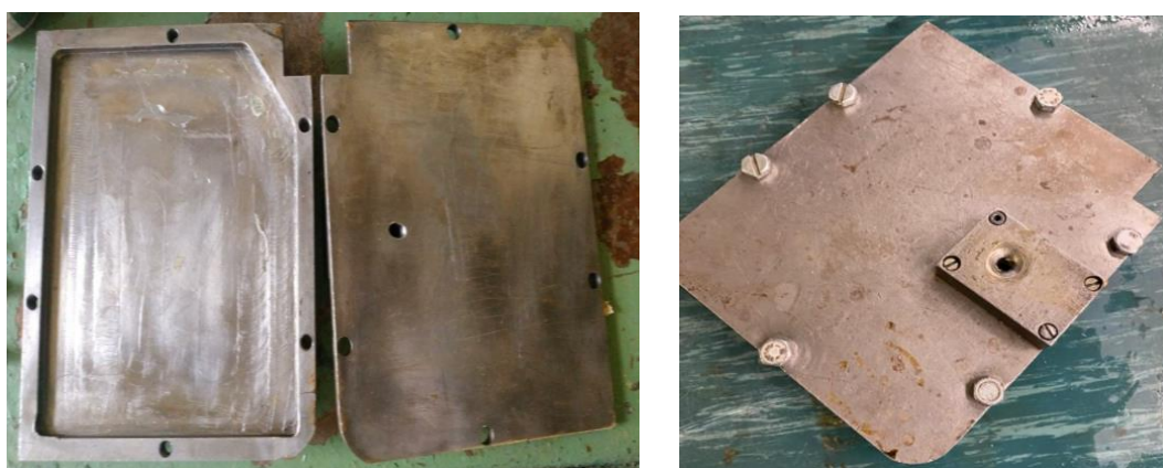
Рис. 5.15. Общий вид эталонной алюминиевой пресс-формы из сплава АК6МЗЦ
