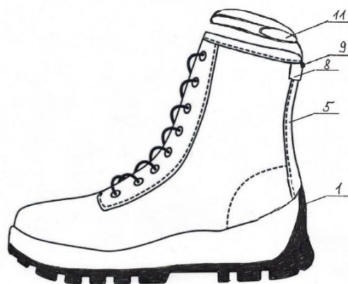
Рис. 5.7. Общий вид устройства антистатической обуви с заземляющими свойствами: 1 – электропроводный слой подошвы; 5 – задний наружный ремень; 8 – карман; 9 – кнопка; 11 – эластичный браслет, в состав которого входят токопроводящие нити
